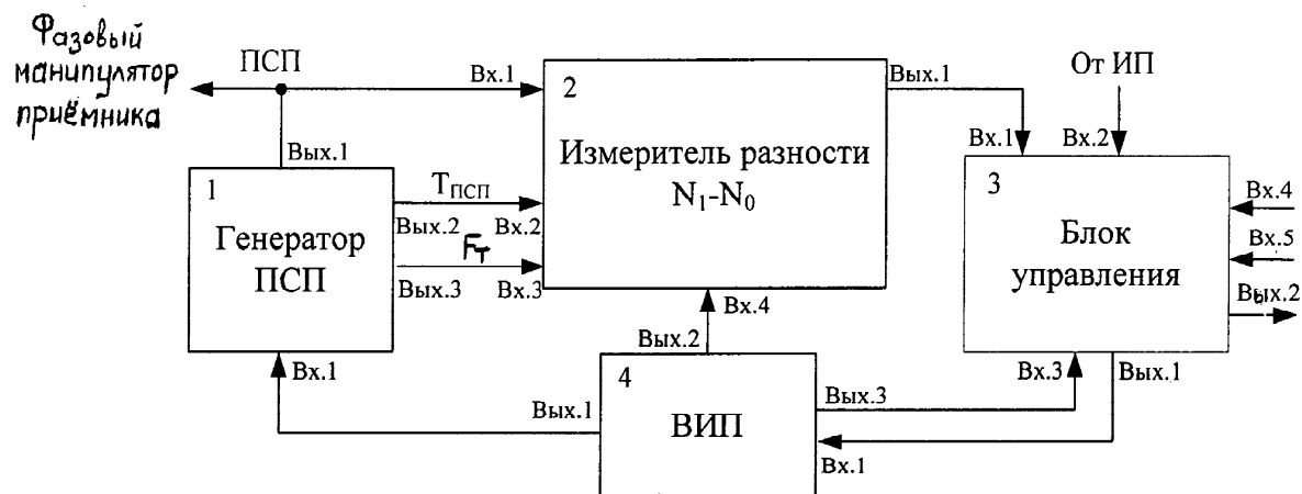
Функциональная схема формирователя периодической последовательности СИМВОЛОВ.
