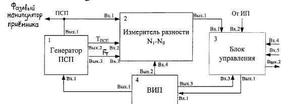
Функциональная схема формирователя периодической последовательности символов.
